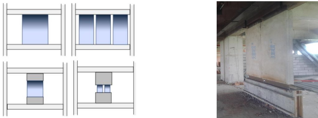
图 2 防屈曲钢板墙 (BRW) 连接方式
